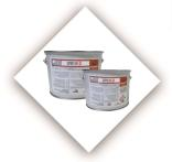
OLY RESIN 20 HTG è una resina epossidica bicomponente tixotropica avente media viscosità, fornita in confezioni predosate con rapporto resina-indurente 2:1. È utilizzabile per l'incollaggio e l'impregnazione di sistemi FRP. OLY RESIN 20 HTG è marcata CE come incollaggio strutturale secondo la EN 1504-4.
