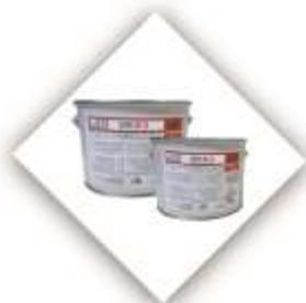
**OLY RESIN 10 HTG** è uno stucco epossidico bicomponente tixotropico, fornito in confezioni predosate con rapporto resina-indurente 4:1. Presenta un'eccellente adesione a svariati supporti e non subisce ritiro nell'indurimento che avviene per reazione chimica. **OLY RESIN 10 HTG** è marcato CE come incollaggio strutturale secondo la EN 1504-4.
